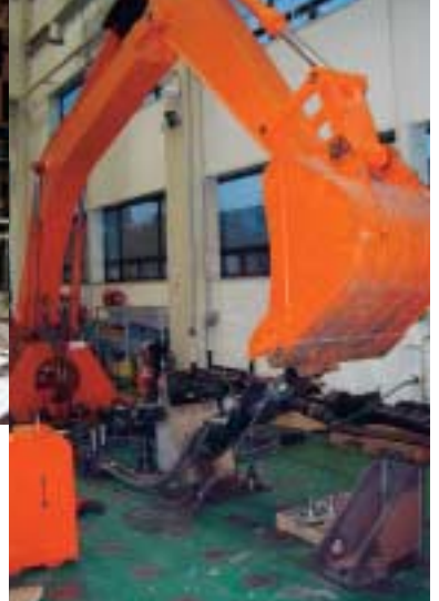
In het R&D Center worden machines en componenten uitentreeën getest en beproefd. Hier een giekl bij de stress tests onder zware belasting.
