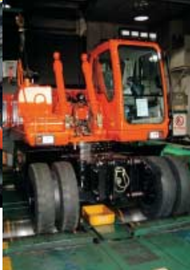
Een mobiele Solar140W-V op de rollenbank voordat hij de fabriek in Incheon verlaat.
